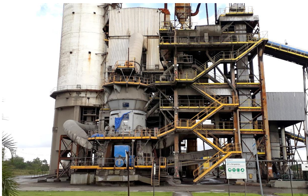
Slika 1 – Vertikalni valjkasti mlin u fabrici cementa.
